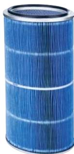
**Fibra-Web<sup>®</sup>** Ofrece soluciones de filtración para aplicaciones con materiales fibrosos, no fibrosos y aglomerativos. Un medio de filtración patentado que incluye la tecnología de nanofibras y una mayor espaciado entre los pliegues proporciona una vida más prolongada del filtro y una eficacia del 99,999% con partículas de 0,5 micrones.
